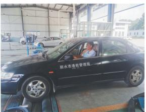
为了检测数据的准确性,需要关闭车 内空调,引车员在闷热的车厢里,专注 的配合完成每一项检测项目。
